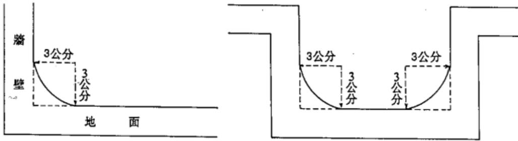
圖 4-01、壁面牆腳及柱腳應具有適當之弧度
