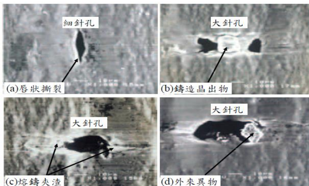
圖三、鋁箔針孔的四種型態
