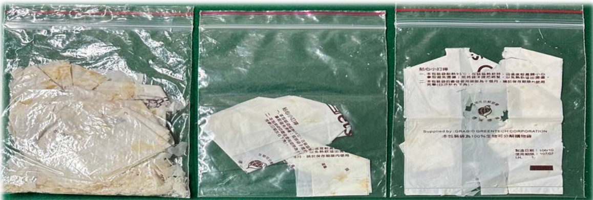
▲100%PLA 袋子 5 年後的分解情況 ▲100%PLA 在無封存袋子分解情況 ▲100%PLA 在密封塑膠袋分解情況
