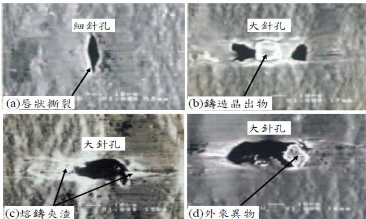
圖三、鋁箔針孔的四種型態
